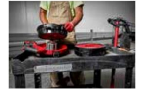
Tambor con sistema anti enganche para una recogida rápida del cable
